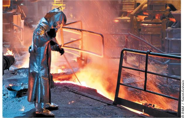
Les fondeurs trient les laitiers à la surface de la fonte en fusion.
