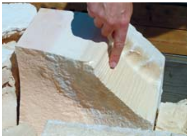
8. Réfractaires verriers avant tout traitement, arrivant sur le site Valoref de Bollène.
