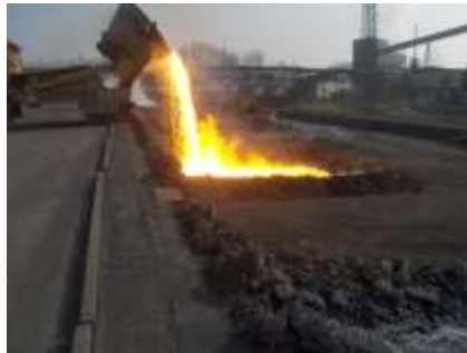
Extraction des laitiers en fusion
