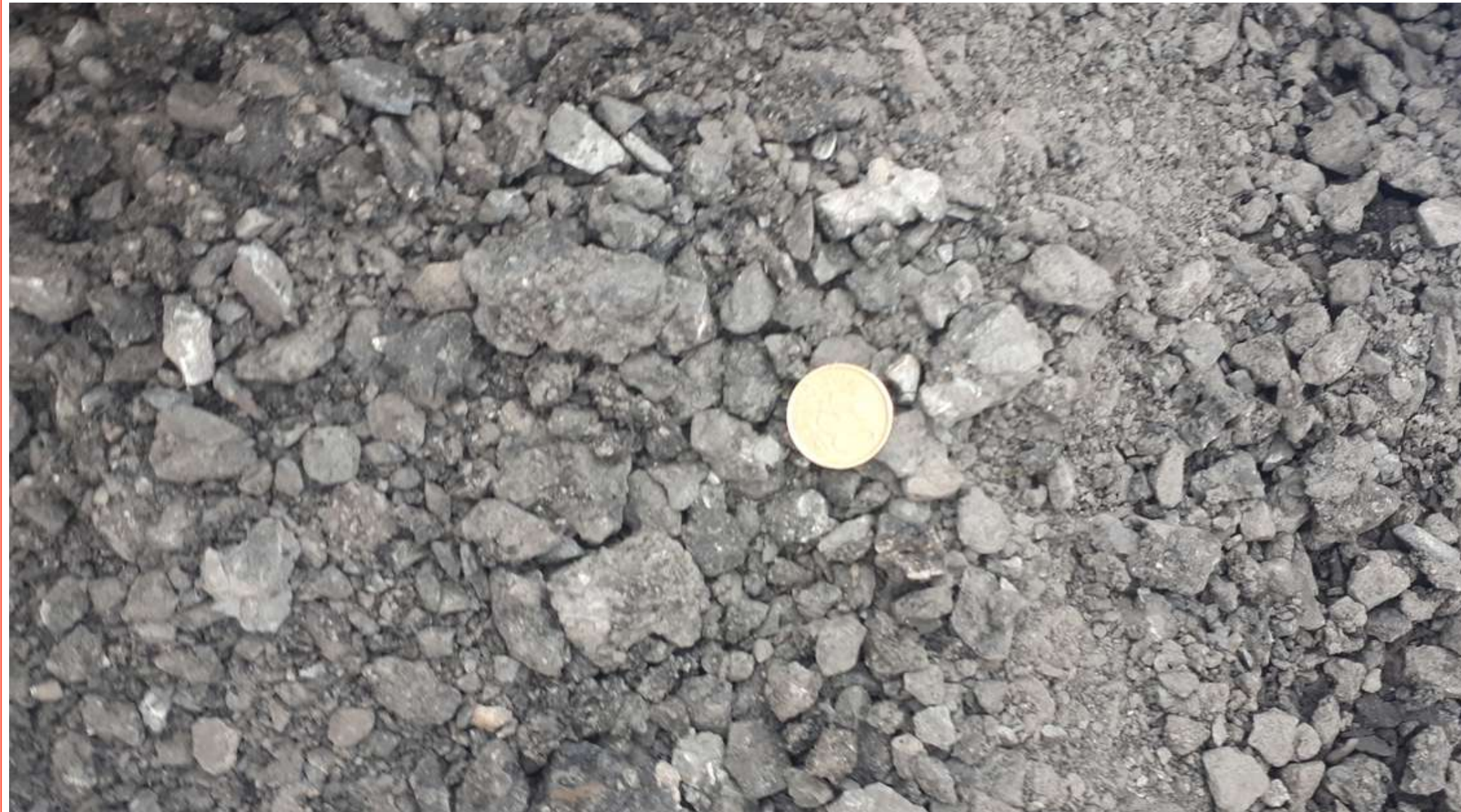
Fraisât 100% Agrégat d'enrobé (100%AE)
