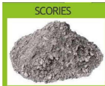
Possèdent des propriétés mécaniques et hydrauliques de grand intérêt dans le domaine de la construction
