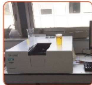
Spectrophotomètre UV-Visible : ici dosage du Cr VI
