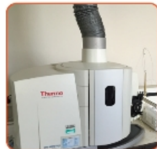
Spectrophotomètre d'émission atomique (ICP torche plasma)
