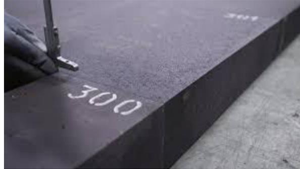
Le verre utilisé pour la fabrication de la laine de verre est très corrosif. Seuls les réfractaires à base de chrome permettent de résister à ces contraintes.
