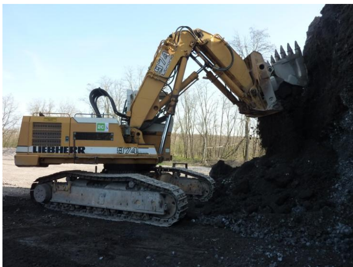
Déroctage à la pelle équipée en butte et mise en stock avant expédition
