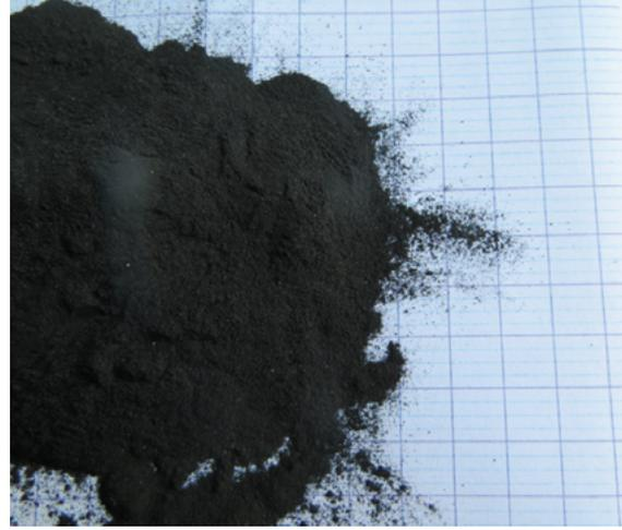
Figure 4 : Échantillons de déchets de purge de sable furanique et de sable à vert (Source : CTIF)
