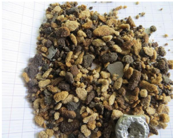
Figure 5 : Echantillons de déchets de sable polyuréthane de criblage (Source : CTIF)
