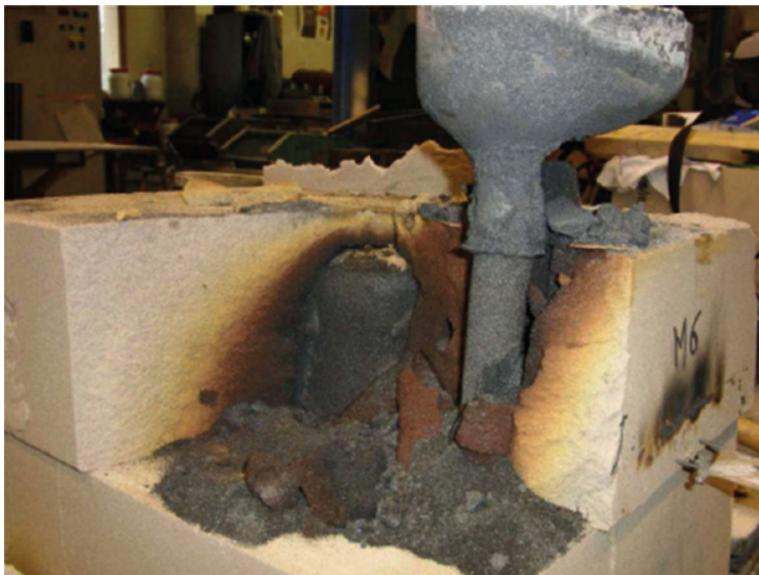
Figure 2 : Sollicitation thermique des sables à la coulée (Source : CTIF)
