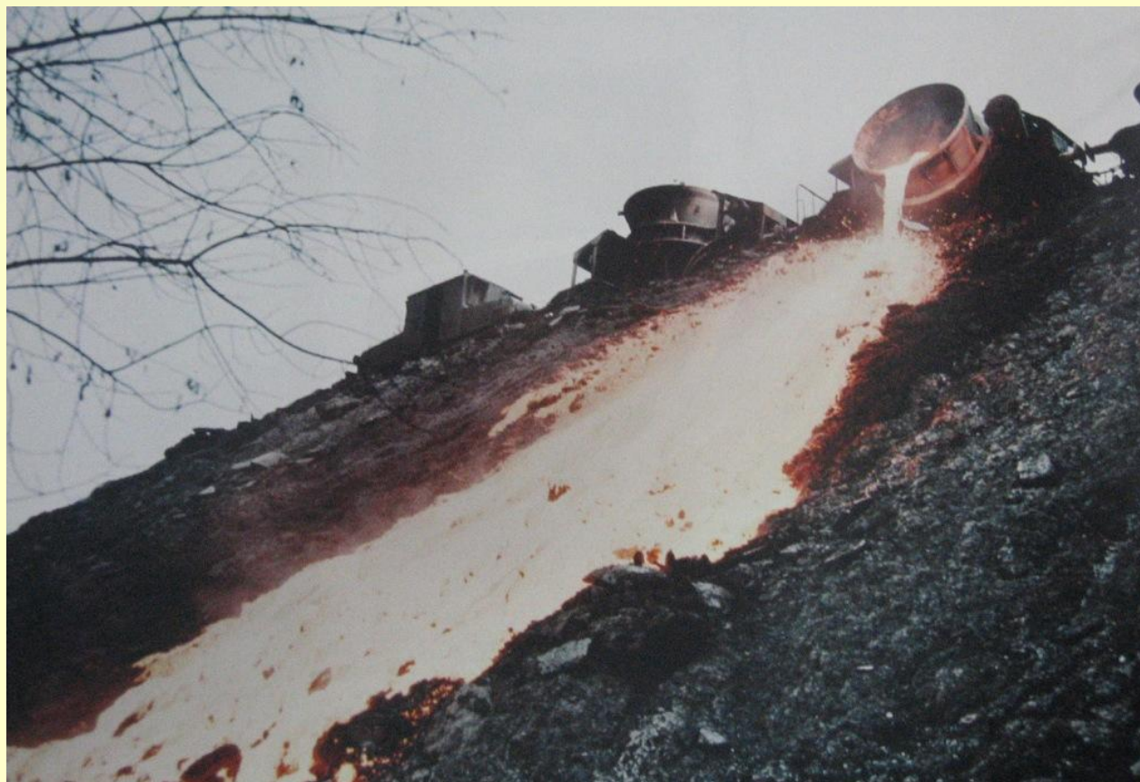
Déversement d'une poche de laitier sur un crassier
