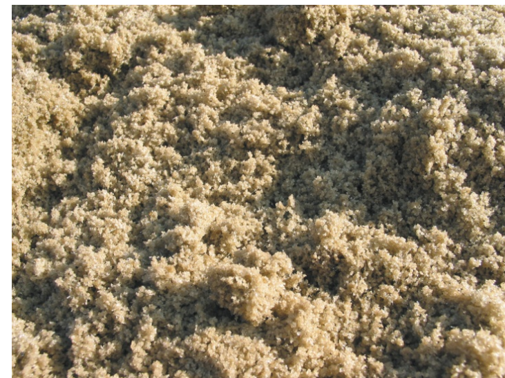
Laitiers de haut-fourneau granulés générés par une usine sidérurgique
